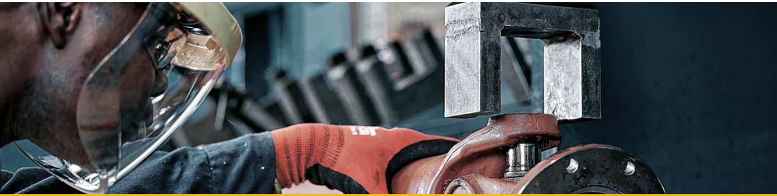
Selbst Komponenten von höchster Qualität funktionieren nicht ordnungsgemäß, wenn sie nicht korrekt installiert und justiert wurden. Fluchtungsfehler führen zu Axial- und Drehschwingungen, Überhitzung, übermäßigem Bauteilverschleiß und reduzierter Lebensdauer des Antriebsstrangs. Energieverluste von über 10 % sind bei falsch ausgerichteten Mehrkomponenten-Antriebssystemen keine Seltenheit.
