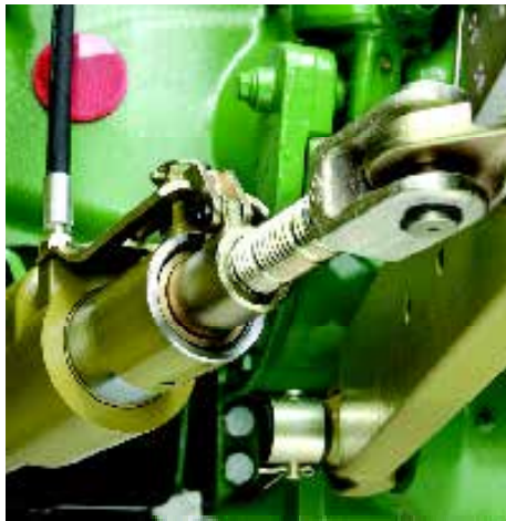
Die hydraulisch gesteuerte Seitenstrebe HGST
