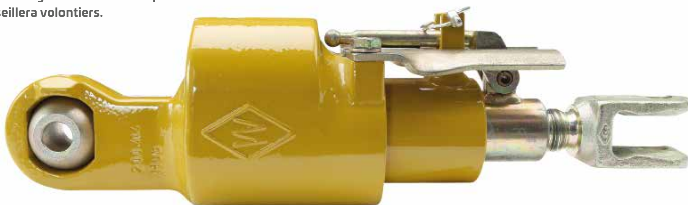
Position rigide des bielles inférieures : pression dans les deux vérins
