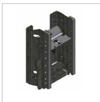
Support d'attelage avec support de la barre oscillante VZP
