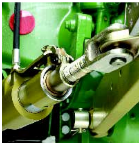
Le stabilisateur latéral à commande hydraulique HGST
