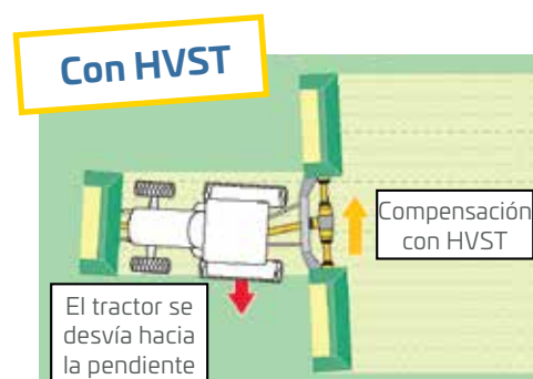
Compensación del error de siega con HVST: el resultado es una área uniformemente segada
