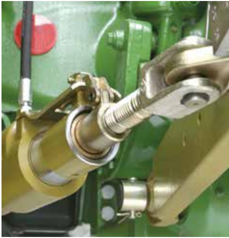
Estabilizador lateral controlado hidráulicamente HGST
