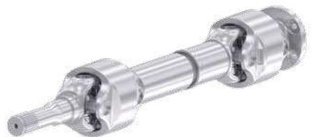
Die Gelenke haben ein robustes Design und zusätzlich einen maximalen Beugewinkel von 50°, wodurch eine hohe Manövrierfähigkeit des Fahrzeugs gewährleistet ist. Diese Wellen sind für den Einsatz in Off-Highway-Fahrzeugen prädestiniert.
