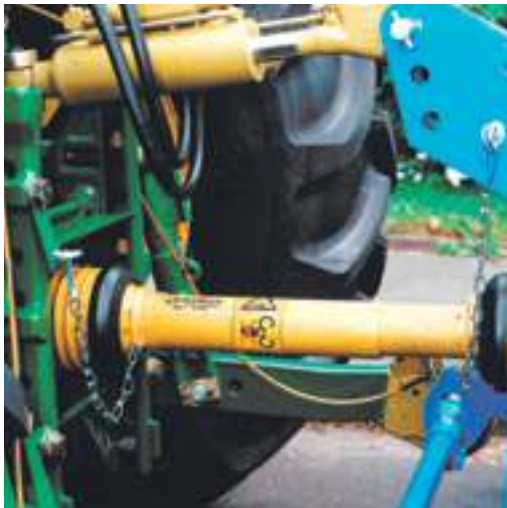
Die Gelenkwelle richtig gesichert mit zwei Halteketten
